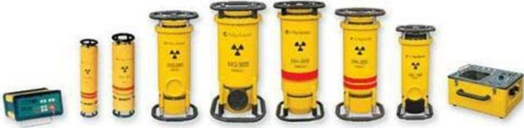
图 9-2 常见 X 射线移动式探伤机
