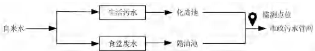
图 3-3 本项目废水处理工艺流程及监测点位图
