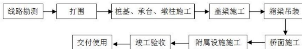
图 2-11 桥梁工程主要施工工艺流程图
